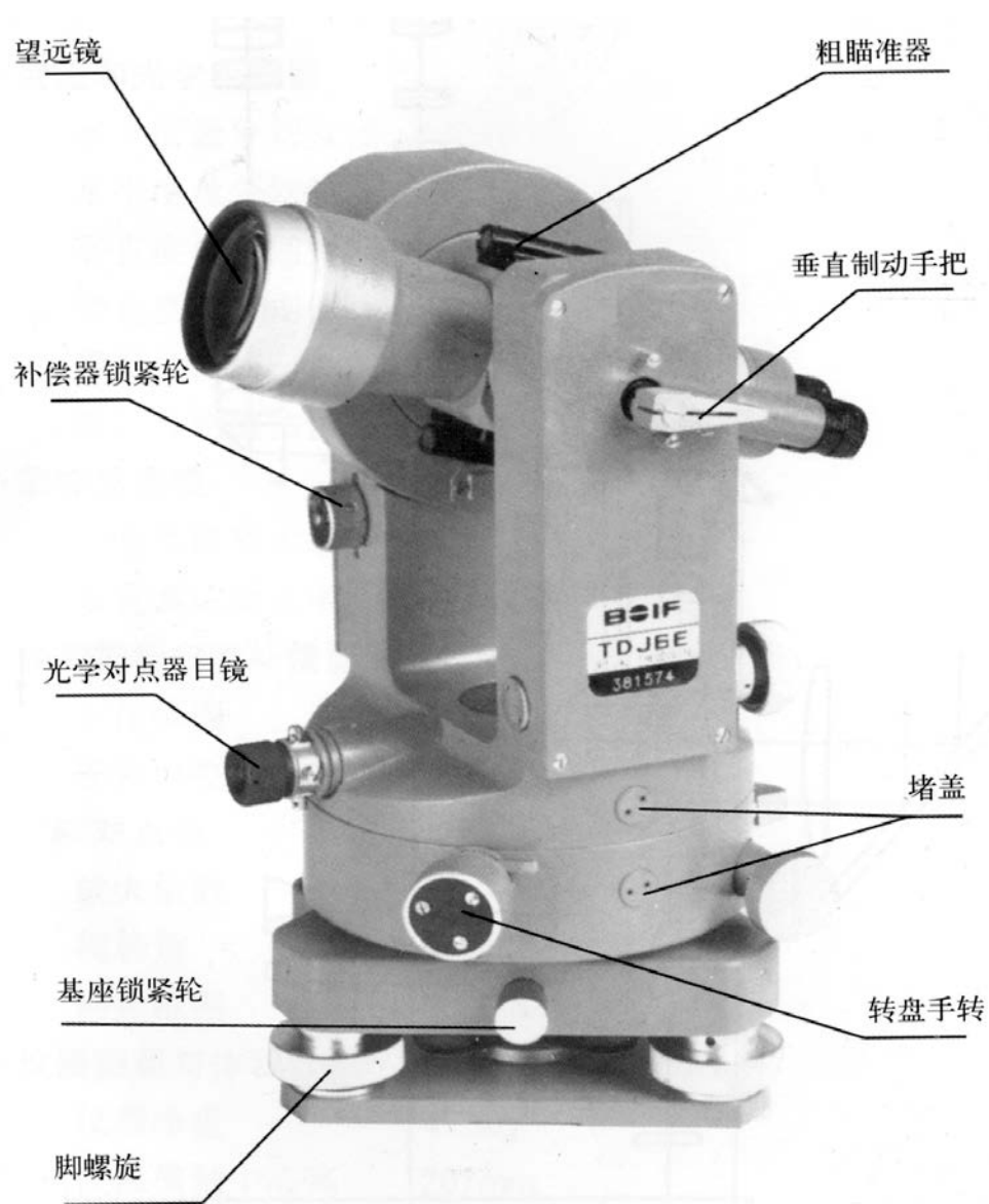
图 2 无磁经纬仪（含磁通门传感器）外形结构图（一）
